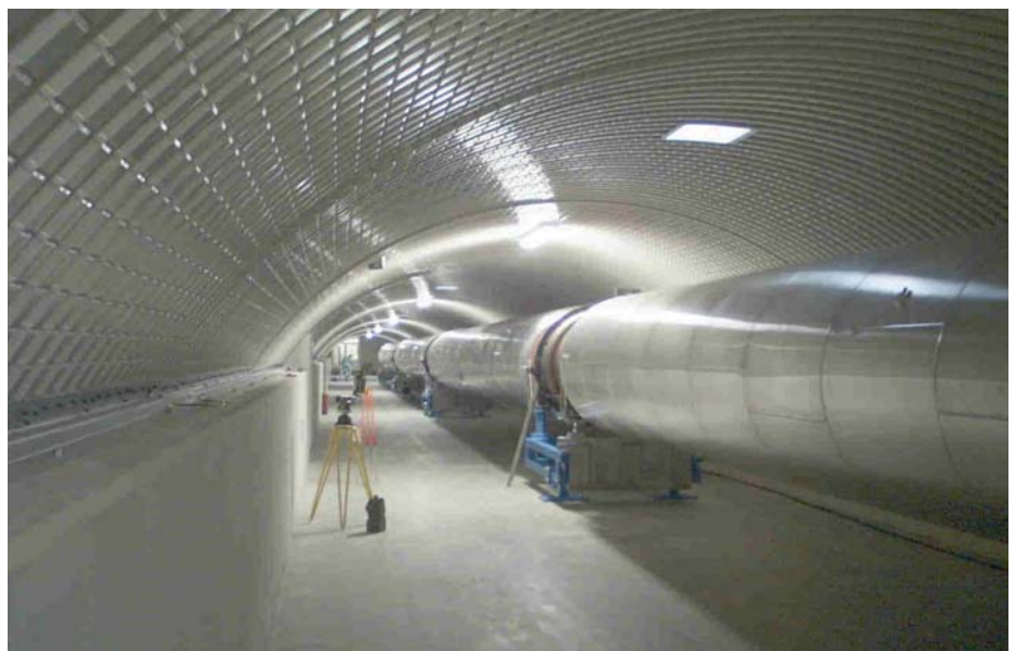
Rury o średnicy powyżej metra, ułożone w każdym z ramion detektora, są największym urządzeniem próżniowym w Europie. Porusza się w nich wiązka lasera.
